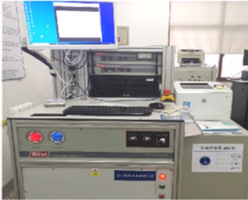
高矫顽力磁体的退磁曲线测试
